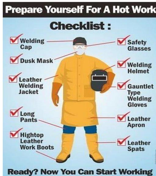
Gambar 2. APD yang wajib dikenakan pada proses las SMAW
