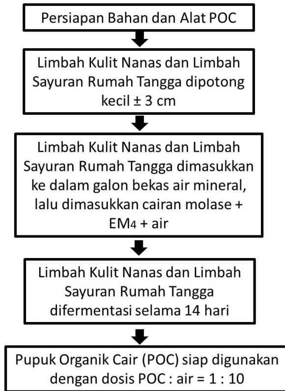
Gambar 1. Skema Pembuatan Pupuk Organik Cair (POC)
