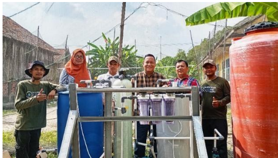
Gambar 9. Teknologi Pengolahan Air Rawa Berbasis Membran
