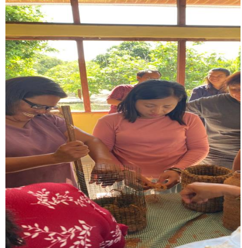
Gambar 1. Pembuatan produk mulai dari memasukan sabuk kelapa pada anyaman kawat yang sudah dibuat
