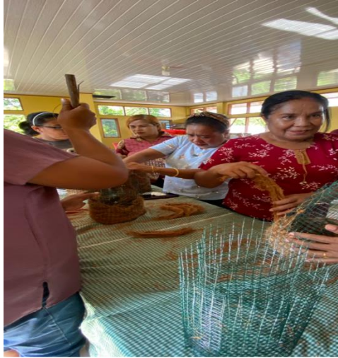
Gambar 1. Pembuatan produk mulai dari memasukan sabuk kelapa pada anyaman kawat yang sudah dibuat
