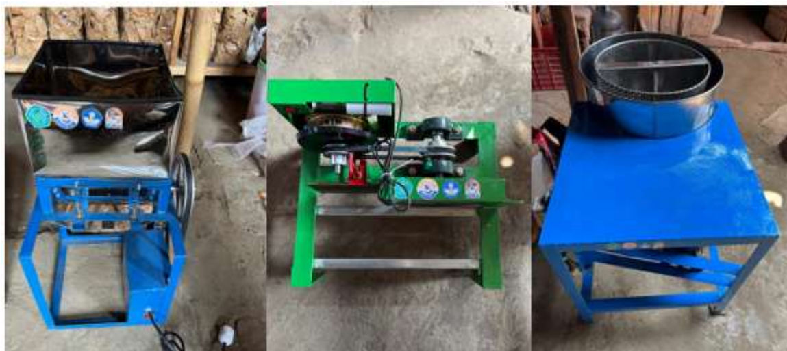
Gambar 3. Mesin pengupas kulit ari kedelai (a), Mesin pemotong tempe otomatis (b), Mesin spinner (c)
