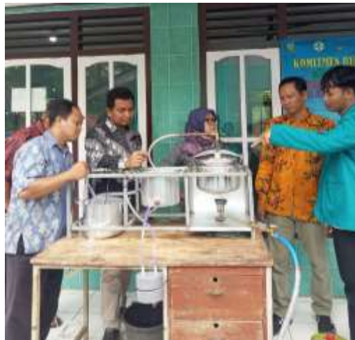
Gambar 3. Proses pengolahan sampah plastik menggunakan prototipe alat pirolisis buatan dosen dan mahasiswa UMNU Kebumen
