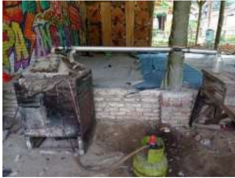
Gambar 3. Pengolahan sampah anorganik dengan metode pirolisis
