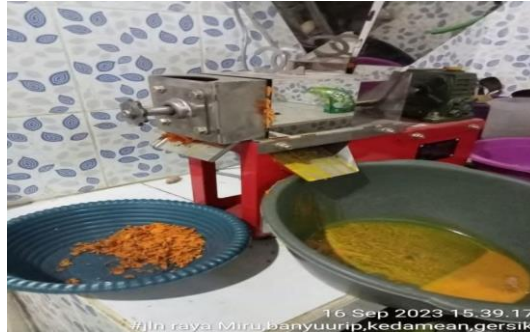
Gambar 2: Mesin Pemas Bahan Jamu
